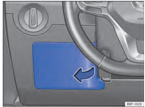
Fig. 156 Del lado del conductor en el panel de instrumentos: cubierta de la caja de fusibles.
