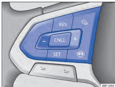
Fig. 106 Lado izquierdo del volante multifunción (variante 2): teclas para controlar el limitador de velocidad.
