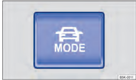
Fig. 100 En la parte superior de la consola central: tecla MODE de selección del perfil de conducción.
