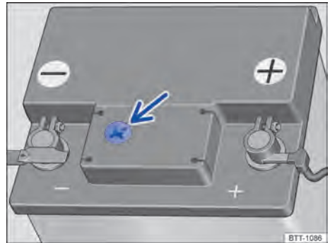
Fig. 176 En el compartimento del motor: ejemplo de posición del visor en el lado superior de la batería del vehículo.
