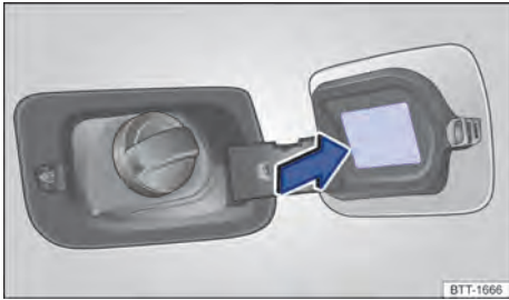
Fig. 180 En la parte interior de la portezuela del depósito de combustible: etiqueta con la presión de los neumáticos.
