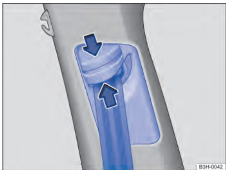
Fig. 31 Junto a los asientos delanteros: regulador de la altura del cinturón de seguridad.
