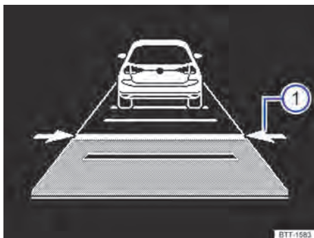
Fig. 111 En la pantalla del cuadro de instrumentos: ajustar la distancia (representación esquemática, el ACC regula).
