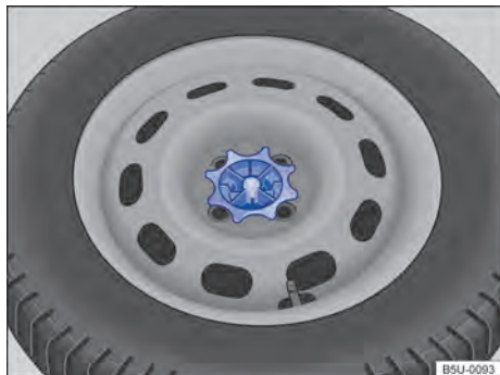
Fig. 182 En el maletero: manivela para fijación de la rueda de emergencia.
