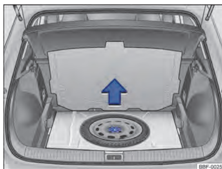
Fig. 150 En el maletero, por debajo del revestimiento del piso: rueda de emergencia y herramientas de a bordo.
