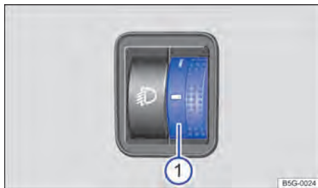
Fig. 74 Al lado del volante: regulador de alcance del faro ① (variación 1).
