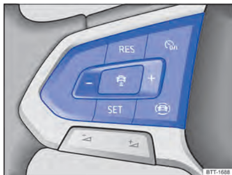
Fig. 110 Lado izquierdo del volante multifunción: teclas para comandar el ACC.
