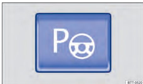
Fig. 118 En la consola central: tecla de encender el asistente de dirección de ayuda para aparcamiento.
