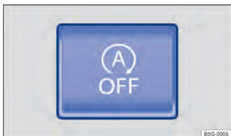
Fig. 93 En la parte superior de la consola central: tecla del sistema Start-Stop.
