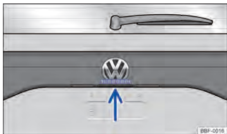
Fig. 56 En la tapa trasera: botón para abrir la tapa trasera.
