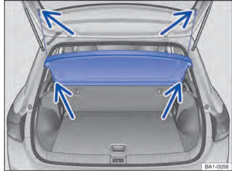
Fig. 144 En el maletero: desmontar y montar la bandeja trasera.
